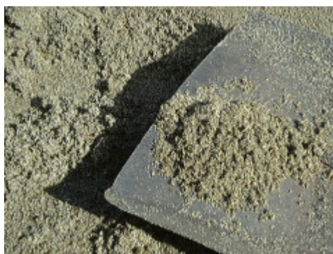
写真4：川砂の例（2ミリ砂）
